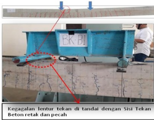
Gambar 11. Mode keruntuhan Balok Kontrol (BK)
