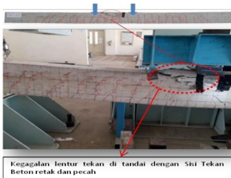
Gambar 12. Mode keruntuhan balok BFS
