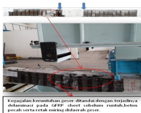
Gambar 13. Mode keruntuhan balok BFTS
